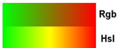
6. sz. ábra. Színinterpoláció a vörös és a zöld szín között az RGB és az HSL színrendszerben.
